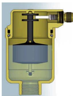
При отсутствии воздуха в системе теплоноситель поднимает поплавок до полного закрытия.
