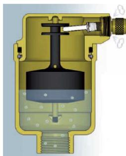
При наличии воздуха уровень теплоносителя опускается и поплавок открывает затвор.
